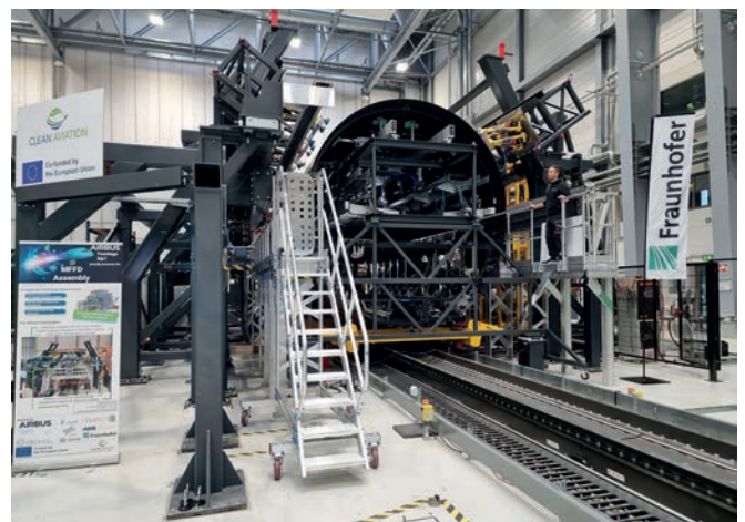
Die »MFFD«-Montage-Forschungsplattform mit eingerüsteten thermoplastischen Rumpfschalen bei der Fraunhofer-Gesellschaft in Stade.
