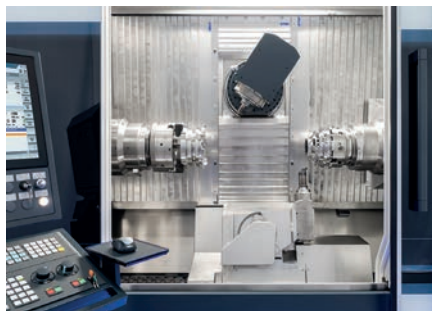
Ein Blick in den Arbeitsraum der M20-G MILLTURN
