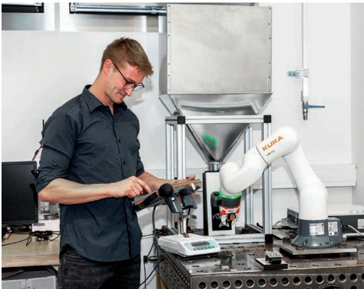
Der Cobot LBR iisy unterstützt die Qualitätskontrolle des neuen Kaffeemahlwerks von Gronbach. In Zukunft könnte er auch bei weiteren Qualitätskontrollen und Prozessen bei Gronbach eingesetzt werden.
