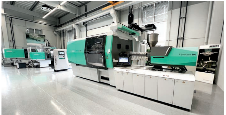
Im Arburg Technology Center (ATC) stehen Allrounder-Spritzgießmaschinen und ein Freeformer für praxisnahe Tests und Werkzeugabmusterungen bereit.
