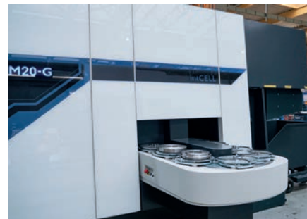
Integrierte Fertigungszelle für automatische Be- und Entladung: intCELL
