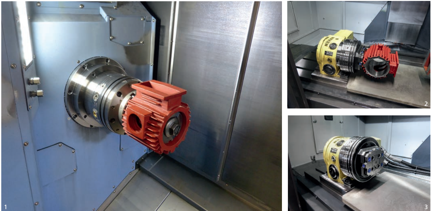
Das Pumpengehäuse wird in der ersten Aufspannung auf einem Hainbuch-Spanndorn mit Schnellwechselsystem centroteX S gespannt (1). Auf dem Schnellwechselsystem centroteX S können bestehende Spannmittel anderer Hersteller adaptiert werden (2). Auf dem centroteX-S-Schnellwechselsystem befindet sich ein weiteres Nullpunktspannsystem zur Werkstückdirektspannung mittels Einzugsbolzen (3).
