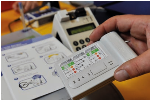
GO-Maut-On-Board-Unit in Vertriebsstelle
