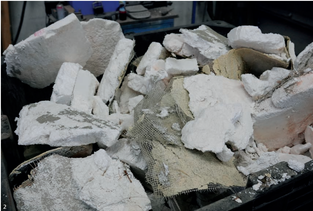
EPS ist nach Abbrucharbeiten mit Fremdmaterialien wie Putz, Klebstoffen, Armierungsgittern und Dübeln vermischt.
