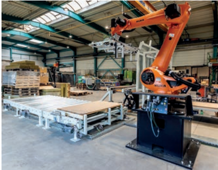
Vollautomatische Palettieranlage für Dämmstoffplatten
