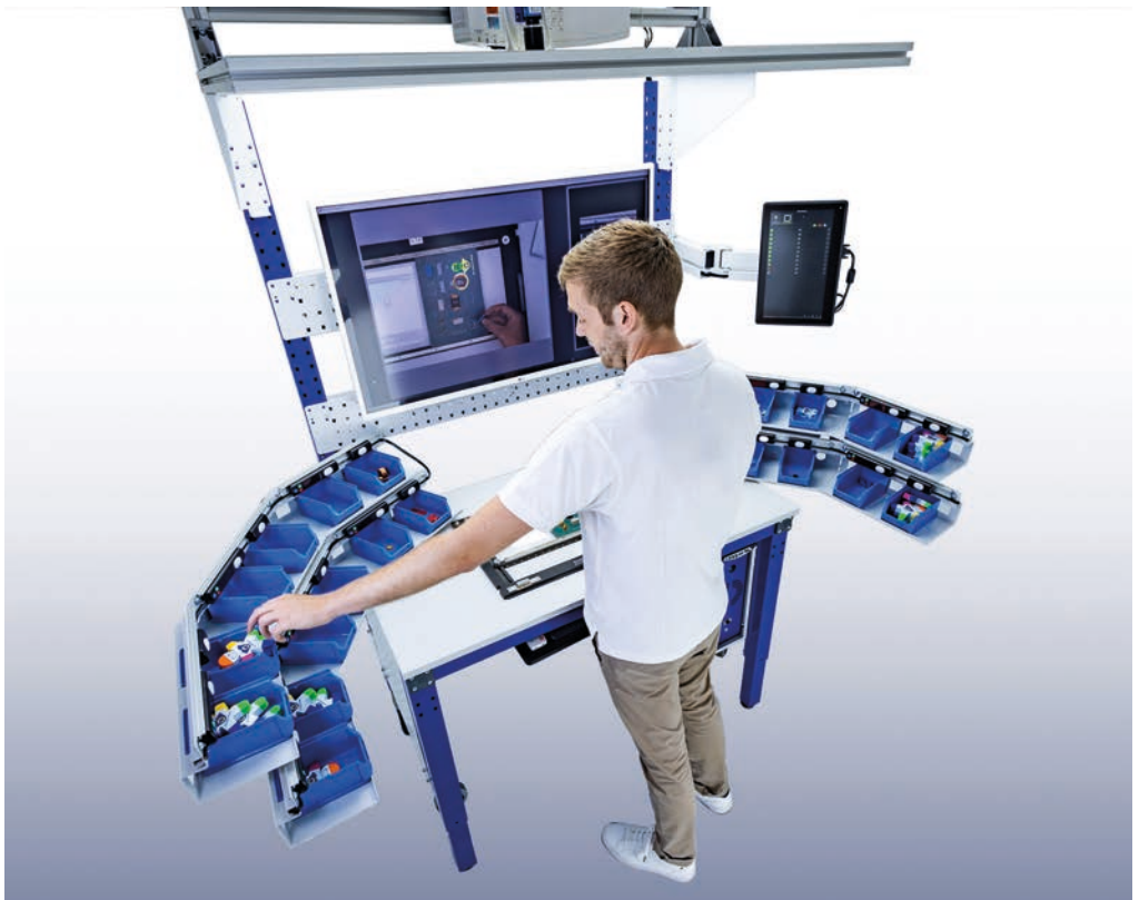
„Der Schlaue Klaus“ ist ein kamerabasiertes Werkerassistenzsystem zur Digitalisierung manueller Prozesse. Es führt anhand einer digitalen Arbeitsanweisung Schritt für Schritt durch den Prozess.
