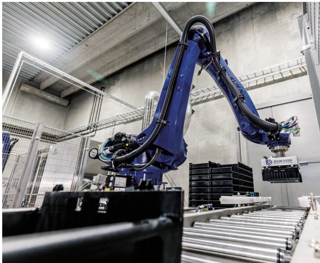
Die Hygienic-Oil-Roboter von Kuka befüllen, leeren und stapeln teilweise extrem schwere Behältnisse.
