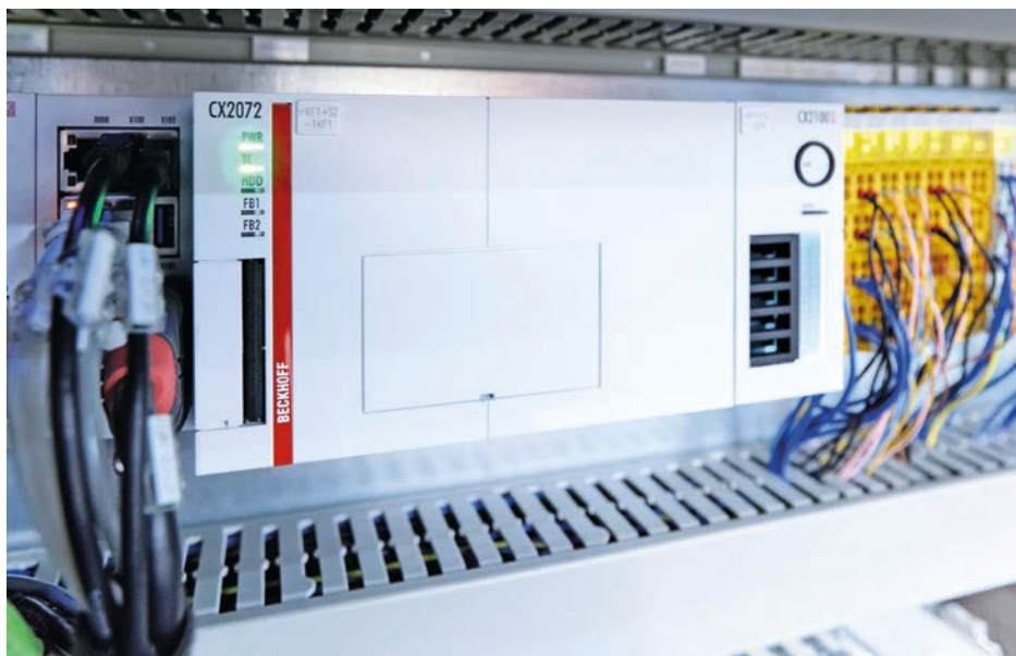
Der Embedded-PC CX2072 mit direkt angereichten EtherCAT- und TwinSAFE-Klemmen steuert alle Bewegungs- und Prüfbläufe.
