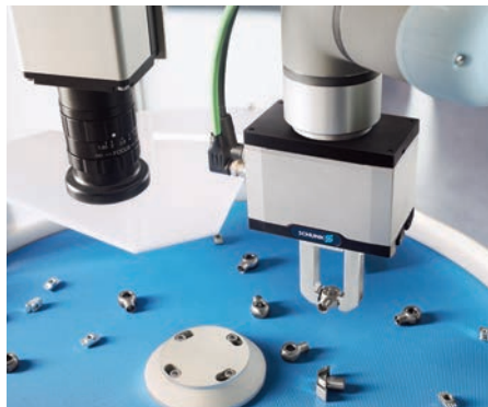
2D Grasping-Kit: leichter Einstieg in KI-gestützte Handhabungsprozesse bei unsortierten Teilen
