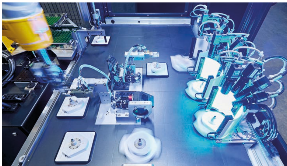
Die XPlanar-Mover bewegen die Bauteile optimiert und im Drei-Sekunden-Takt durch den Prüfprozess.
