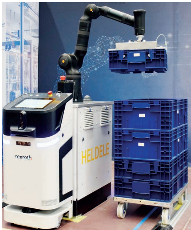
Die Cobot-Station wird mit dem AMR ACTIVE Shuttle von Bosch Rexroth an ihren Arbeitsplatz transportiert und erhält Informationen vom Produktionsleitsystem. Dann beginnt der 7-Achsen Leichtbauroboter KR810 autark seine Arbeit.
