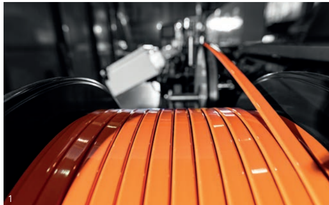
HPW produziert speziell isolierte Flachdrähte, sogenannte Busbars, aus Kupfer und Aluminium als Stromschiene zwischen Elektromotor und Batterie oder zur Verbindung der einzelnen Batterieelemente (1).
