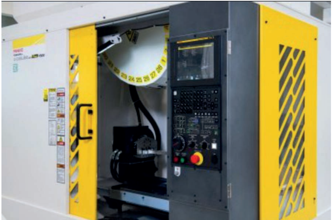
Der erweiterte 500 mm Y-Achsen-Hub des Robodrill bietet bei vielen Anwendungen neue Bearbeitungsmöglichkeiten.
