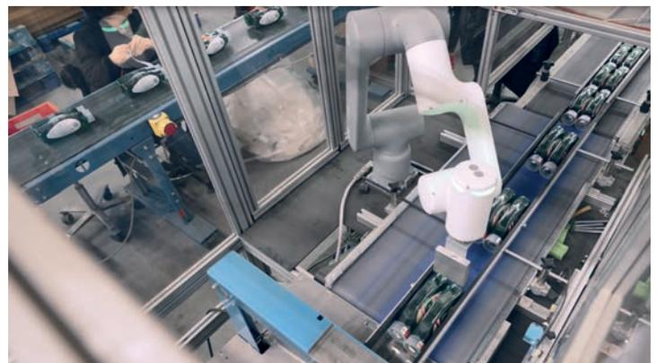
GoFa ist für die Handhabung von Traglasten von 5, 10 und 12 kg ausgelegt. Mit einer TCP-Geschwindigkeit von 2,2 m/s ist GoFa schneller als andere Cobots seiner Klasse.
