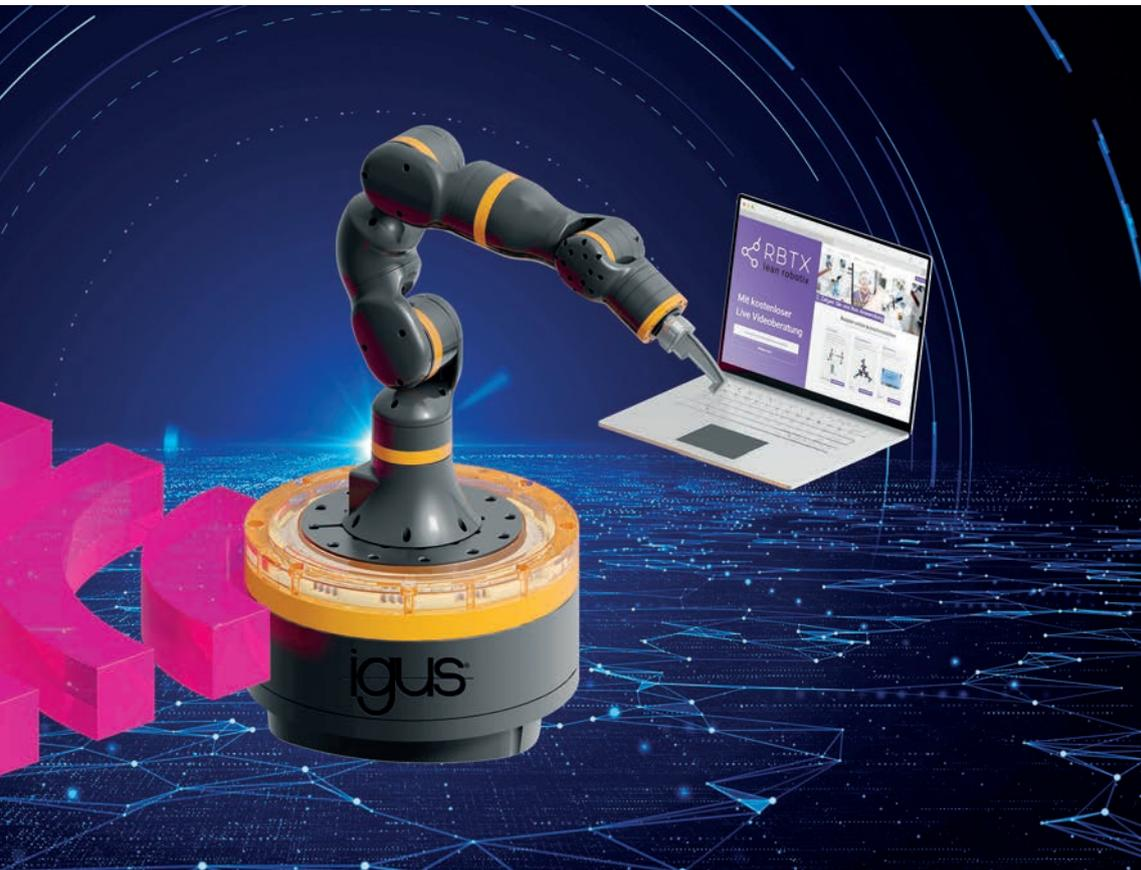
Beim ReBeL setzt igus ganz auf seine Motion-plastics-Expertise: Der Einsatz von Kunststoff macht den Roboter mit 8,2 Kilogramm Eigengewicht zum leichtesten Serviceroboter.
