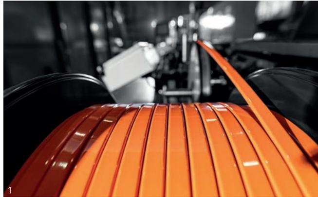
HPW produziert speziell isolierte Flachdrähte, sogenannte Busbars, aus Kupfer und Aluminium als Stromschiene zwischen Elektromotor und Batterie oder zur Verbindung der einzelnen Batterieelemente (1).
