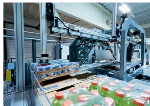
Die bisher einzigartige Taschensortelösung der Serie AutoPocket eröffnet neue Möglichkeiten der Automatisierung in der Pharmalogistik (3). Runpick bearbeitet und palettiert Großgebilde vollautomatisch und steigert die Leistung in der Filialbelieferung im Lebensmittelhandel (4).
