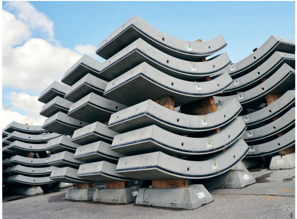
Über 19.000 Tübbingsegmente (sechs Segmente bilden einen Tübbingring) werden bei der Maba südlich von Wien bereits seit November 2023 vorproduziert.
