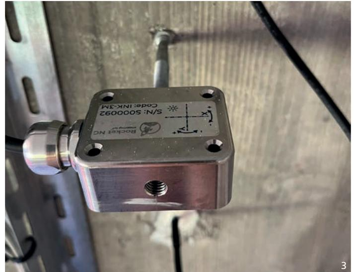
Ein Piezometer erfasst den Wasserdruck auf die Brücke und im Bauwerk (2). Ein Inclinometer misst die Neigung des Brückenpfeilers (3).
