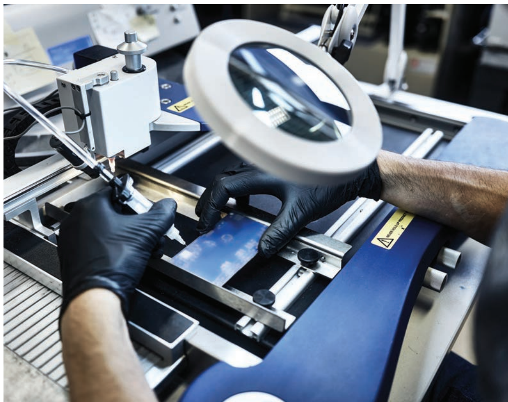
Bestückung im Produktionsprozess einer Prototypenplatine. Hier halbautomatisiert
