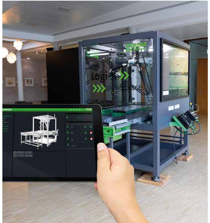
Das Vario-X-System ermöglicht eine einfache, schaltschranklose Installation und Verdrahtung sowie eine flexible Integration in Bestandsanlagen und Neumaschinen (li.). Der digitale Zwilling ermöglicht präzise Überwachung und vorausschauende Wartung, optimiert Betriebsabläufe, fördert effiziente Prozesse, beugt Stöorzuständen vor und erhöht die Anlagenlebensdauer (re.).
