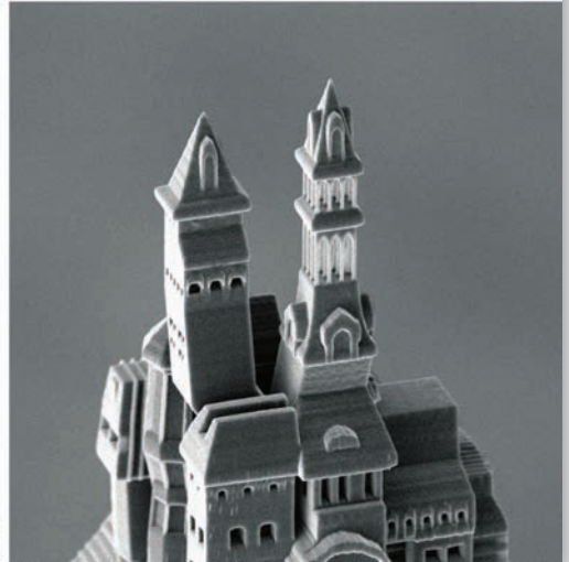
Das im Nano-3D-Druck hergestellte Schloss auf der Bleistiftspitze beeindruckt durch feinste Details. Horizontal sind Strukturen kleiner als 200 Nanometer, vertikal kleiner als 550 Nanometer möglich.
