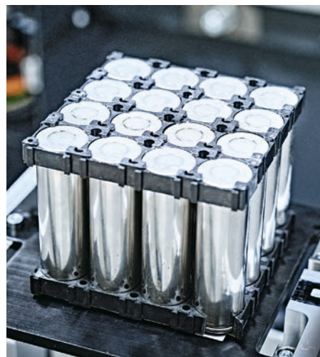
Beispiel für ein aus Rund-Batteriezellen aufgebautes Lithium-Ionen-Batteriemodul
