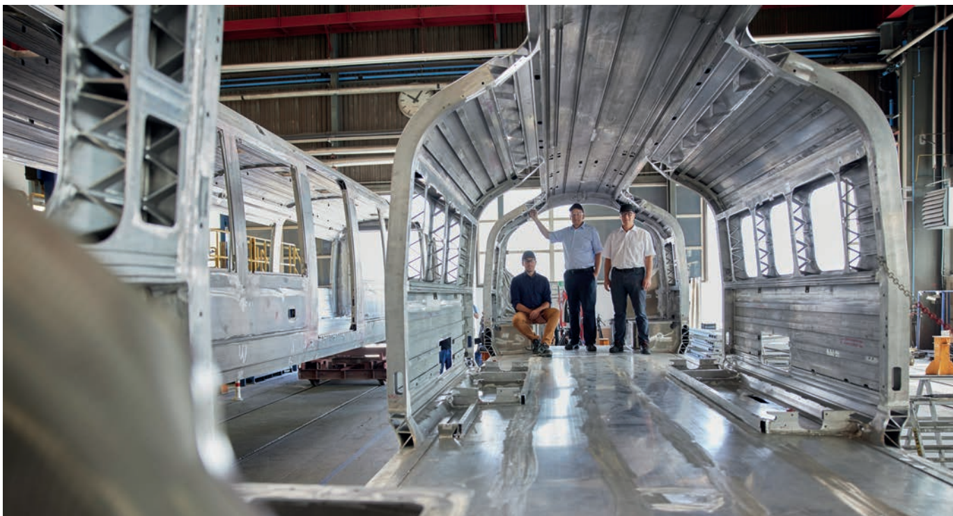
Am Siemens-Mobility-Standort Wien wurden die bionischen Wagenkästen in Zusammenarbeit mit der TU Wien entwickelt. Mit modernster Optimierungssoftware haben die Forscher Markus Seitzberger, Robert Nedelik und Andreas Ruthmeier analysiert, wie Material im Wagenkasten durch subtraktive Fertigung eingespart werden kann.
