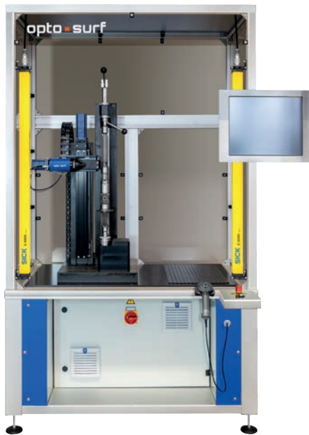
OptoShaft 012 ist eine automatische Messmaschine, die motorisch verschiedene Lager anfahren kann und dort in mehreren Ebenen die Rundheit, Welligkeit und Rauheit messen kann. Mittels einer Fourier-Transformation ermittelt die Software periodische Anteile (Ordnung und Amplitude) und stellt diese als Diagramm bzw. Zahlenwert dar.
