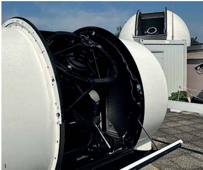
1 Sende- (hinten rechts) und Empfangsteleskop (vorne links) im bistatischen Messaufbau am Observatorium Lustbühel
