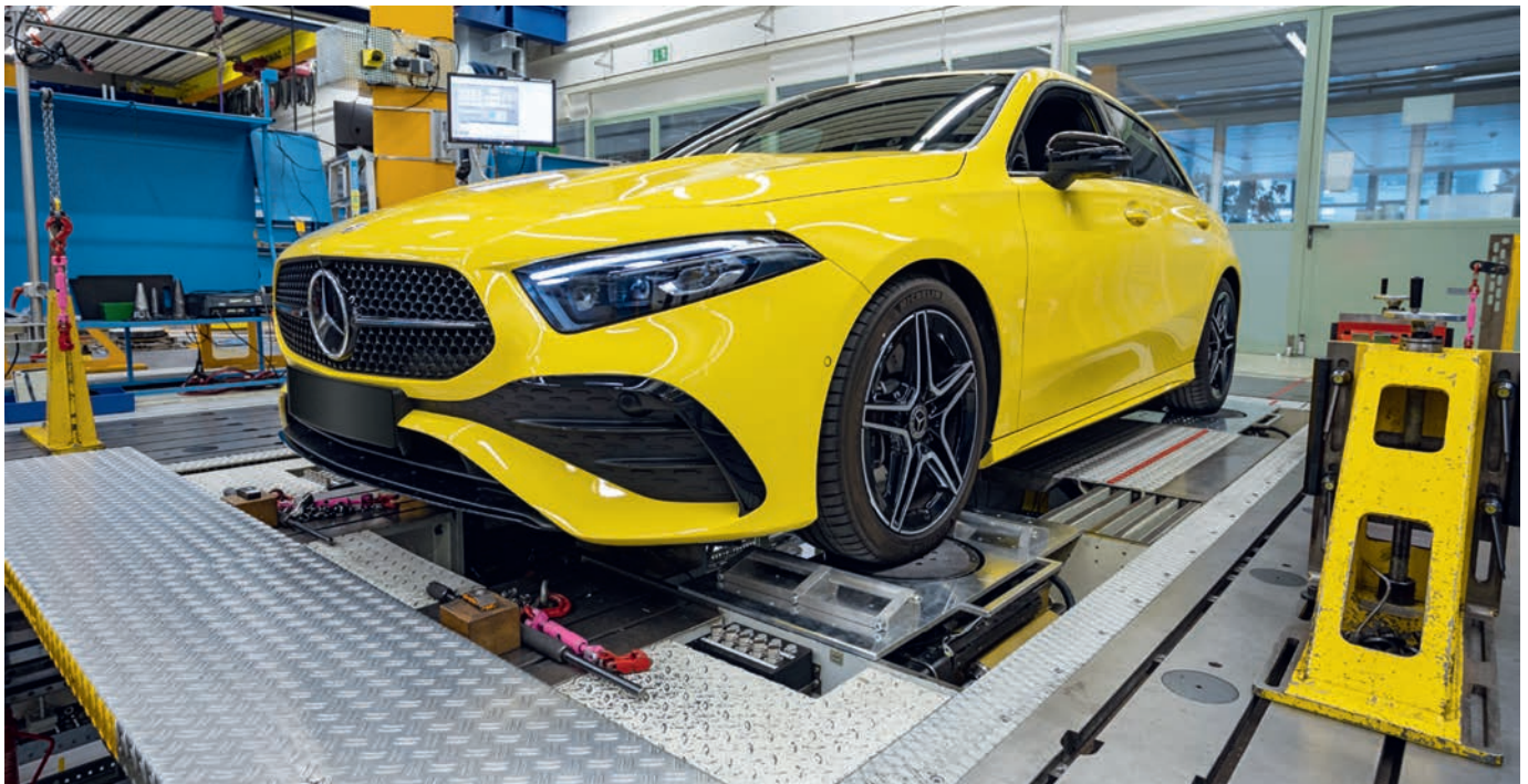
Auf mehreren Prüfständen analysiert und optimiert Mercedes-Benz mithilfe von Präzisionsmesstechnikklemmen der ELM-Serie und der Software TwinCAT die fahrdynamischen Eigenschaften kommender Fahrzeuggenerationen.
