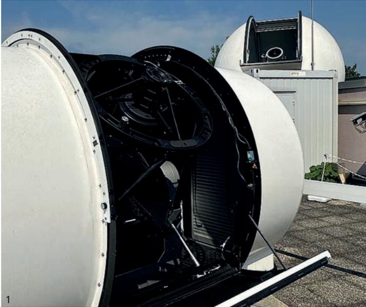
1 Sende- (hinten rechts) und Empfangsteleskop (vorne links) im bistatischen Messaufbau am Observatorium Lustbühl
