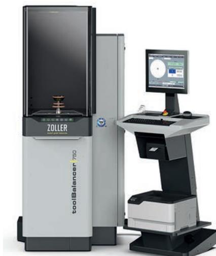
*Der „toolBalancer“ bringt Werkzeuge in die perfekte Balance (li.). TMS Tool Management Solutions ist ein effizientes Toolmanagement-System von Werkzeugen und Schleifscheiben (re.).*
