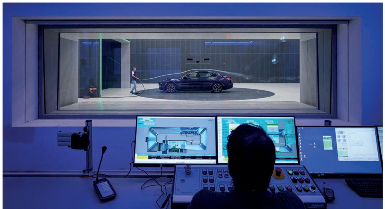
Mit einem Hintergrundgeräuschpegel (54,3 dB[A] bei 140 km/h), der so niedrig ist wie ein leises Gespräch oder eine leise Klimaanlage, können die Geräusche, die durch den Fahrtwind am Fahrzeug entstehen, im neuen Windkanal präzise gemessen werden.
