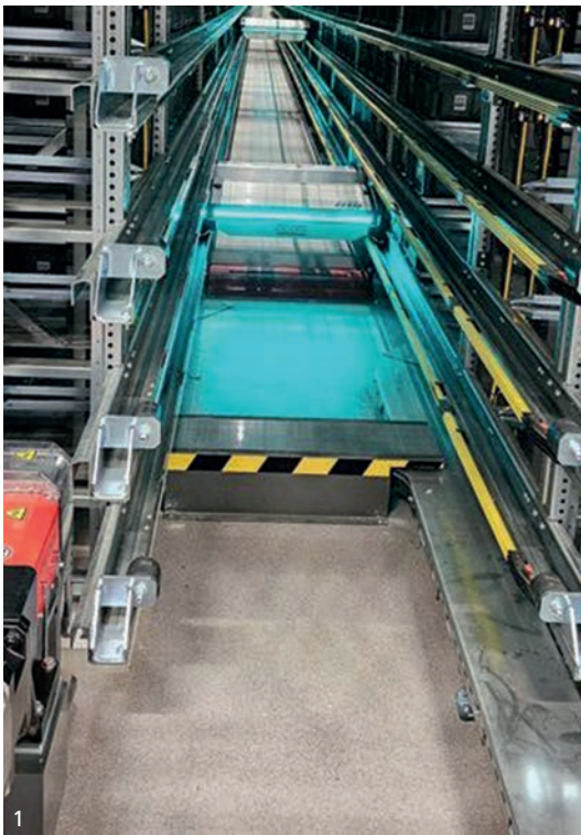
GC Europe entschied sich für eine umfassende Automatisierungslösung, basierend auf dem Evo-Shuttle-System von Knapp (1). Die ergonomischen Ware-zur-Person-Arbeitsplätze der Serie Pick-it-Easy von Knapp entlasten die Mitarbeiter (2).
