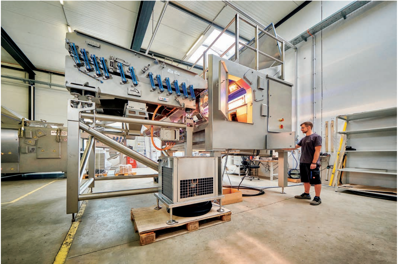
Die größten Sherlock-Separatoren können bis zu 70 Tonnen Kartoffeln in der Stunde kontrollieren.
