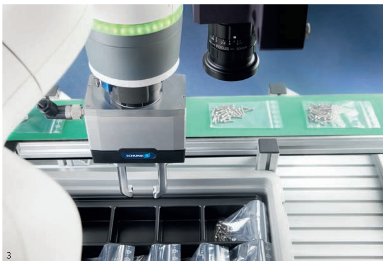
„Gripping meets Robotics“ – Die Robotertechnologietage sind eine Plattform für den Austausch innovativer Technologien und Best-Practice-Anwendungen im Bereich der automatisierten Produktion (2). Das mit dem HERMES AWARD ausgezeichnete 2D Grasping-Kit wurde von SCHUNK für den schnellen Einstieg in die autonome Handhabung nicht lageorientierter Objekte entwickelt (3).
