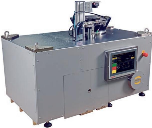
zum Einsatz, die sich seit Jahren in Harting-60-kN-Werkzeugen bewährt haben. Der mögliche Zeitgewinn lässt sich an Energieinfrastruktur-Projekten verdeutlichen: Leistungsfähige Kabelkonfektionen bis 70 A können mit dem Stripper-Crimper in großem Maßstab industriell vorkonfektioniert und vor Ort mit geringem Aufwand in die Infrastruktur integriert werden.
