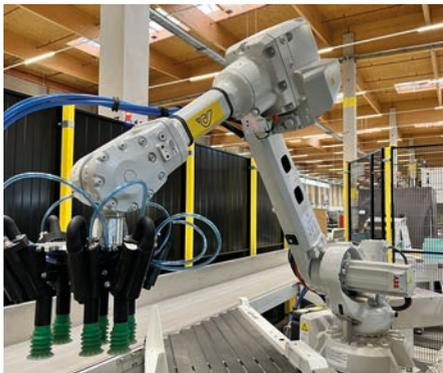
Der Auflegeroboter Robin, kurz für ROBotic INduction, im Einsatz
