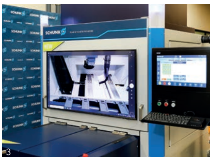
Laser-Nutzentrenner SCHUNK speedLAS® SAL-1300
