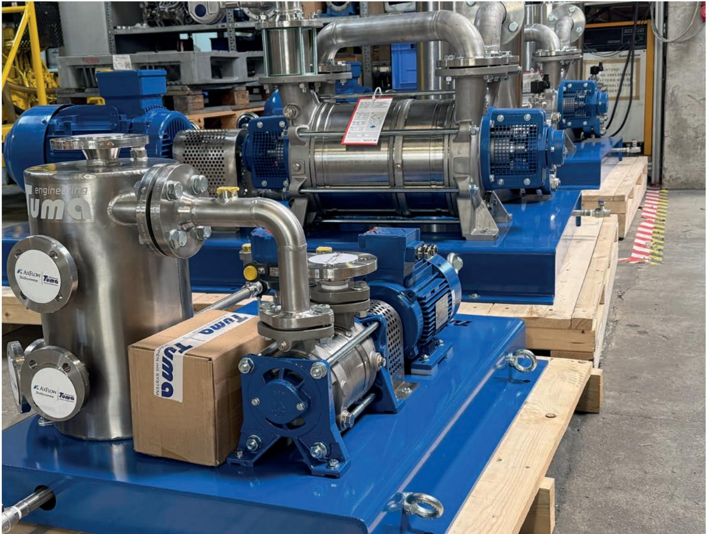
Die Flüssigkeitsring-Vakuumpumpen von TUMA fördern und verdichten Gase in diversen Anwendungen und werden in besonderen Ausführungen auch zum Fördern von explosiven Gasen, z. B. von Wasserstoff und Dämpfen, eingesetzt.
