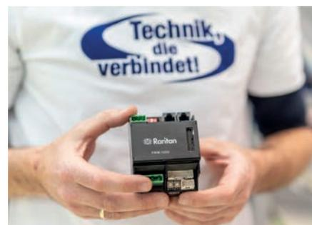
System zur Stromkreisüberwachung, das sich flexibel in bestehende Anlagen integrieren lässt und maximale Transparenz schafft – bis auf Abzweigebene. Das Besondere: Das System von Raritan ist ideal für die Nachrüstung geeignet, etwa in Rechenzentren, Industrieanlagen oder gewerblichen Gebäuden. Ohne kostspielige Umbauten lässt sich damit ein umfassendes Strom-Monitoring realisieren – vom Hauptverteiler bis zur letzten Steckdose. Eine Lösung, die Effizienz und Ausfallsicherheit deutlich erhöht.
