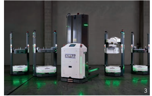
Das 2D Evo Shuttle von Knapp ist ein zentrales Element der Lagerlogistik bei Novogenia (li.) Die Open Shuttles von Knapp transportieren sowohl Behälter als auch Paletten über alle Ebenen (re.).
