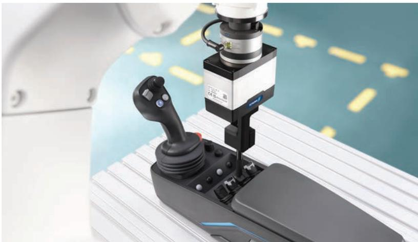
Der Kraft-Momenten-Sensor FTS erfasst Prozesskräfte und -momente mit hoher Auflösung und Genauigkeit und führt so zu präzisen Ergebnissen und gleichbleibender Qualität in der automatisierten Fertigung.
