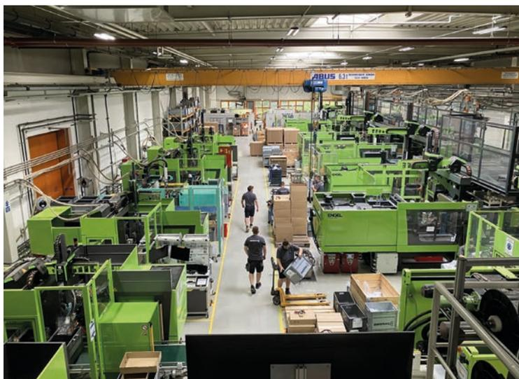
Über 800 Tonnen Polycarbonat verarbeiten die Spritzgussmaschinen jährlich zu Ampeln für den Weltmarkt.
