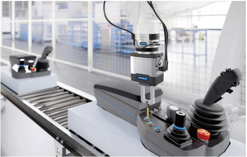
Die Haptikmessung im Automotivebereich erfolgt durch Greifen und Bewegen des Joysticks sowie die Betätigung von Knöpfen mit einer Prüfspitze.
