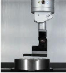
**Mit dem MarSurf MC 510 bietet Mahr eine innovative automatisierte Lösung, um Oberflächenrauheiten an Werkstücken direkt in der CNC-Fertigungsmaschine zu messen – normgerecht und hochgenau.**
