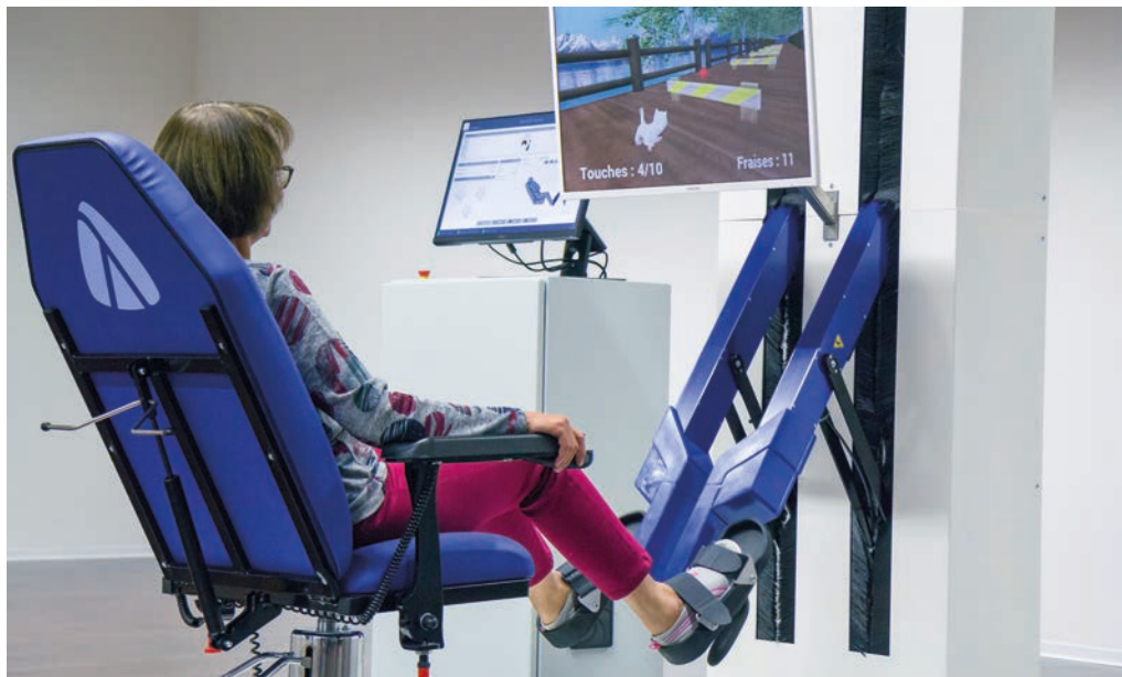
In Therapierobotern, ähnlich wie dem Gerät im Bild, hilft die Unterstützung bei der präzisen Bewegung einzelner oder mehrerer Gelenke bei der Mobilisation von Patienten.
