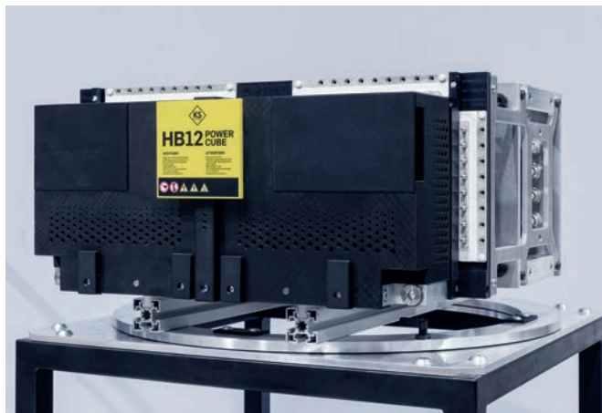
Leiterplatten und Leistungselektronik: Die von KS Engineers entwickelten „PowerCubes“ wandeln elektrische Energie flexibel in unterschiedliche Formen von Strom und Spannung um.
