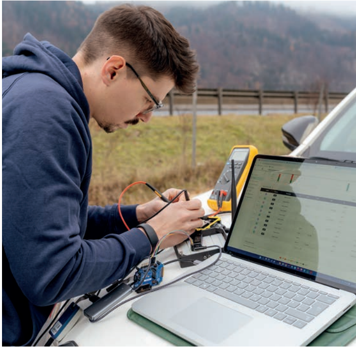
Finaler Funktionstest eines intelligenten autonomen Sensorsystems vor Montage an einer Steinschlag-Schutzverbauung
