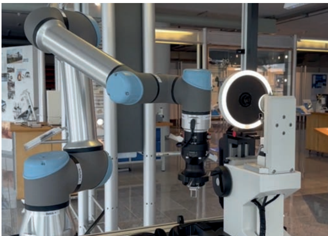
Die automatische Bestückung mit einem Cobot erweitert ein Messuhrenprüfgerät von Feinmess Suhl in Richtung Industrie 4.0.
