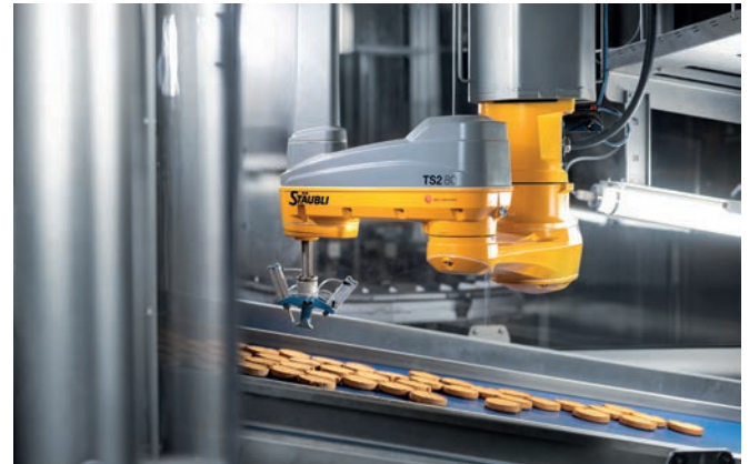
Das Inspektionssystem mit deckenmontiertem Roboter prüft 1.200 Zwiebackscheiben pro Minute.
