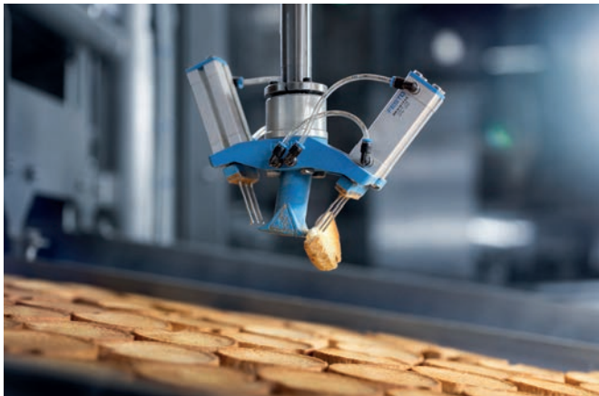
Ein speziell entwickelter Nadelgreifer greift die auszusortierenden Scheiben.
