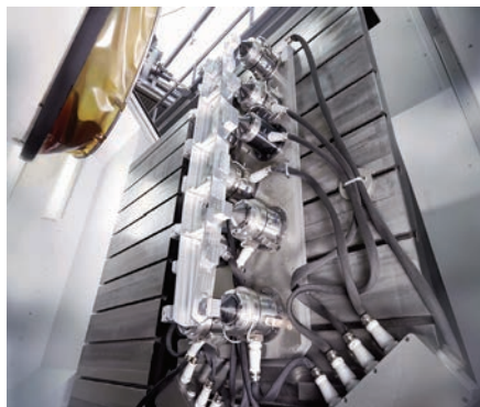
SCHUNK Engineering für Luft- und Raumfahrt: Aufspannung von Strukturbauteilen mit VERO-S Aviation.
