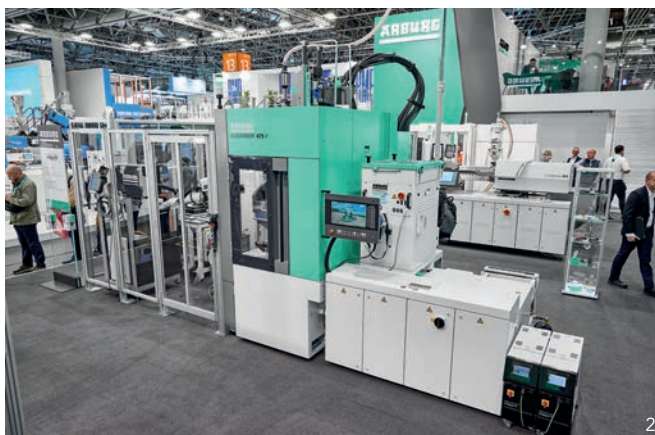
Eine Fertigungszelle rund um einen neuen vertikalen Allrounder 475 V produzierte auf der K 2025 hochwertige Funkenschlüssel-Cover aus PC/ABS-Rezyklat in Kombination mit In-Mould-Decoration (IMD), inklusive Kennzeichnung und Nachbearbeitung.
