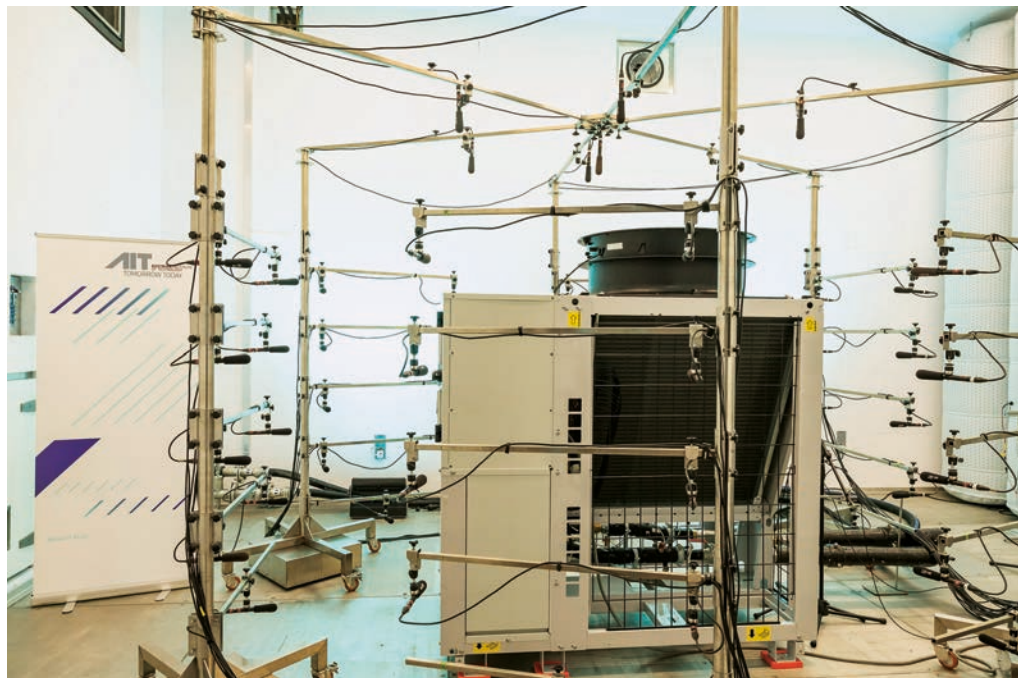
Das AIT bietet Schalldruck- und Schallleistungsbestimmung sowie Messungen in den akustisch optimierten Klimakammern und strömungstechnische Untersuchungen an.
