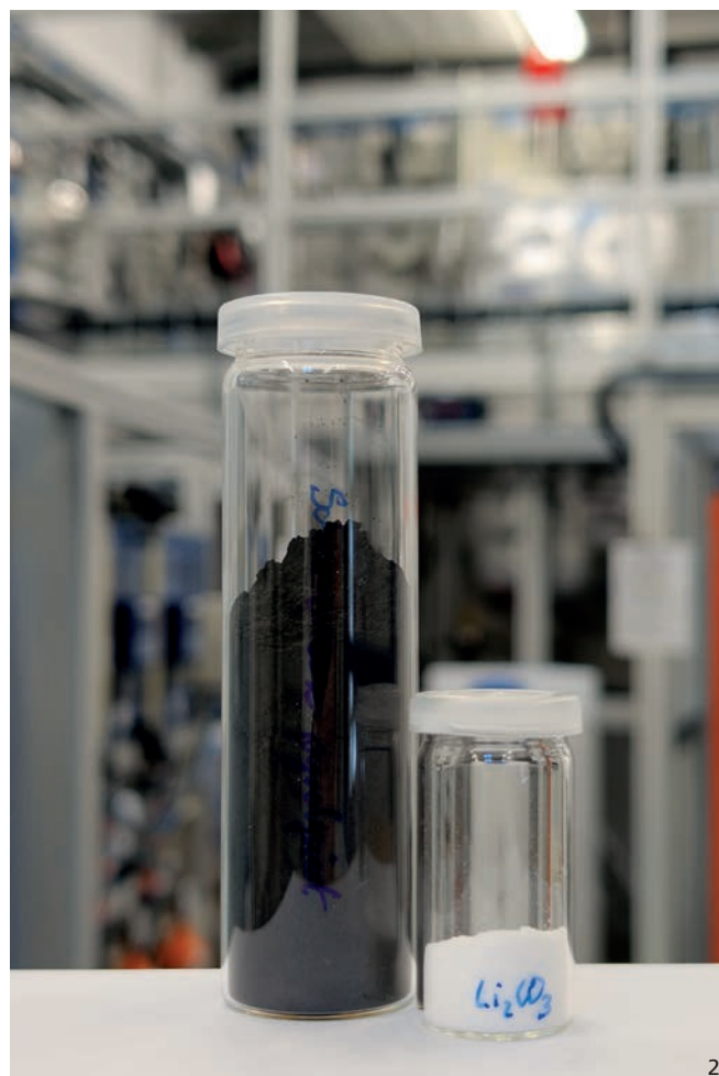
Schwarzmassegewinnung: mittels Cool-Verfahren aus Schwarzmasse extrahiertes hochreines Lithiumcarbonat
