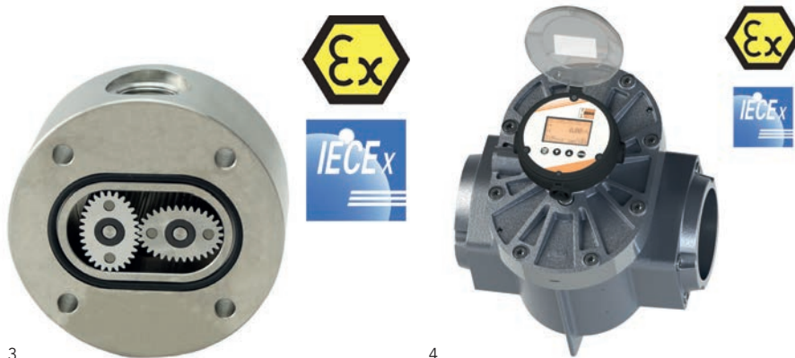
Ovalradzähler sind Verdrängungsvolumenzähler, bei denen sich zwei Ovalräder in einer Präzisionsmesskammer drehen. Mit jeder Umdrehung passiert ein festes Volumen von Flüssigkeit das Messgerät (3). Drei Erfassungselektroniken mit LCD-Anzeige bieten ausgereifte Lösungen für eine Vielzahl von Messaufgaben (4).
