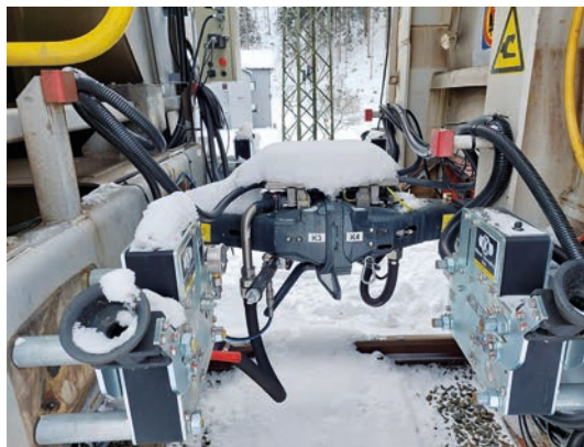
Im Rahmen des Tests ließ man bewusst Schnee in alle relevanten Komponenten eindringen.
