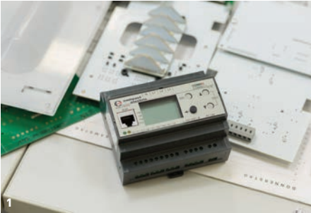
Das CDMRN-Connect überwacht Spannung, Frequenz und Phasenlage.
