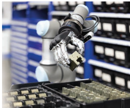
Im Mittelpunkt stehen Fünf-Finger-Greifhände mit integriertem Handgelenk und Unterarm.
