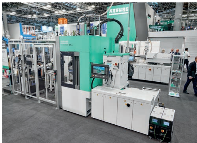
Eine Fertigungszelle rund um einen neuen vertikalen Allrounder 475 V produzierte auf der K 2025 hochwertige Funkschlüssel-Cover aus PC/ABS-Rezyklat mit In-Mould-Decoration (IMD), inklusive Kennzeichnung und Nachbearbeitung.
