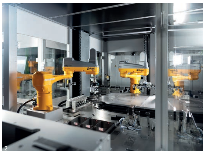
Zwei Staubli SCARA-Roboter, ein kompakter TS2-60 und ein großer TS2-100, arbeiten bei der Beladung der Spritzgießmaschine Hand in Hand (1). In der direkt angeschlossenen QS-Zelle durchlaufen die Teile elektrische, mechanische und drei KI-gestützte Kameraprüfungen (2). Die Staubli-Vierachsroboter überzeugen bei Promotech mit Präzision, Dynamik und Verfügbarkeit (3).
