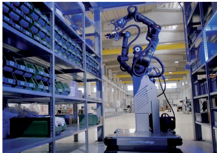
Mobile Robotik ist in der Intralogistik bereits etabliert, humanoide Robotik rückt zunehmend in den Fokus. Hier zu sehen ist ein humanoider Roboter von Bosch Rexroth auf einer AMR-Plattform (Autonomous Mobile Robot), wie er ein entsprechendes Bauteil in einem Regal sucht.
