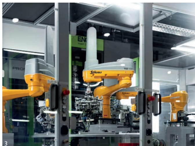
Zwei Staubli SCARA-Roboter, ein kompakter TS2-60 und ein großer TS2-100, arbeiten bei der Beladung der Spritzgießmaschine Hand in Hand (1). In der direkt angeschlossenen QS-Zelle durchlaufen die Teile elektrische, mechanische und drei KI-gestützte Kameraprüfungen (2). Die Staubli-Vierachsroboter überzeugen bei Promotech mit Präzision, Dynamik und Verfügbarkeit (3).
