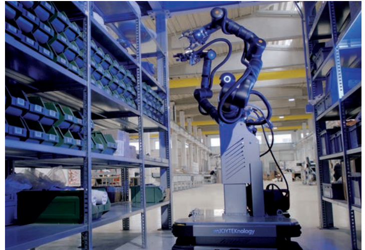
Mobile Robotik ist in der Intralogistik bereits etabliert, humanoide Robotik rückt zunehmend in den Fokus. Hier zu sehen ist ein humanoider Roboter von Bosch Rexroth auf einer AMR-Plattform (Autonomous Mobile Robot), wie er ein entsprechendes Bauteil in einem Regal sucht.
