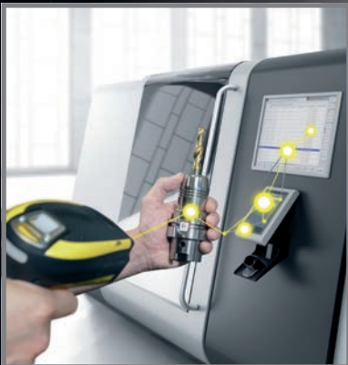
Datenübertragung sämtlicher digitaler Werkzeugdaten mit ZOLLER »idCode«
