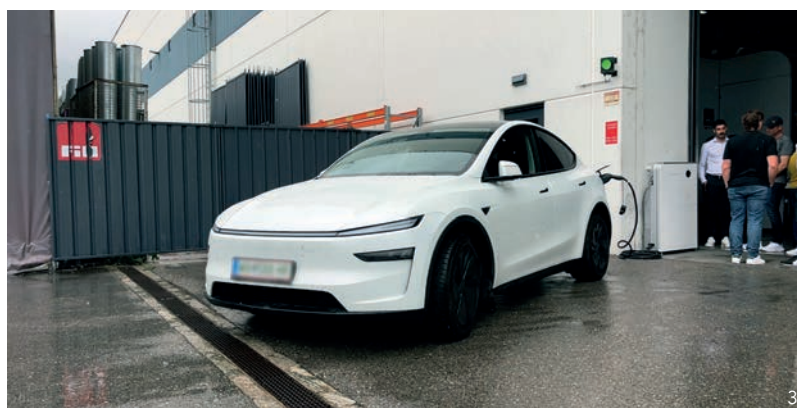
Der Schaltschrank der Austrian DC Pilot Factory steuert das Zusammenspiel von Photovoltaik, Produktionsanlagen und bidirektional ladenden Elektrofahrzeugen innerhalb des Gleichstromnetzes (Bild links). Bidirektional ladende Elektrofahrzeuge werden intelligent in das Energiesystem integriert und können überschüssige Energie speichern sowie bei Bedarf wieder bereitstellen (Bild rechts).
